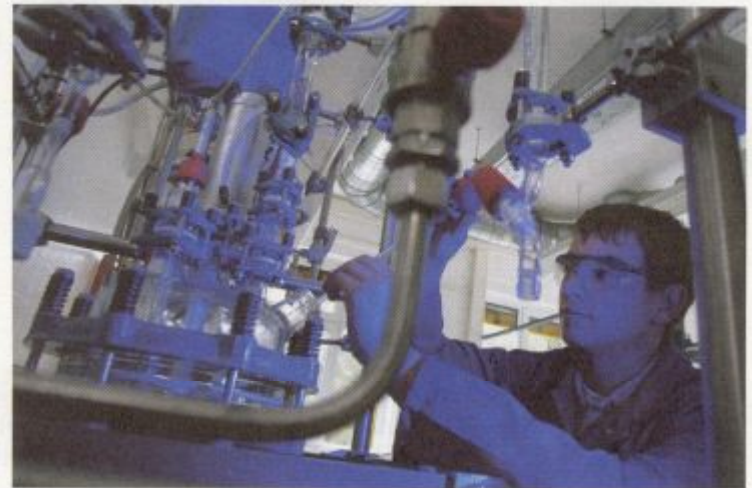
Chemikant Robert Koppe entnimmt eine Probe aus einem Reaktor. An der so genannten Miniplantanlage lernen die Azubis chemische Reaktionen im Kleinformat. (Fotos: Rasche)
